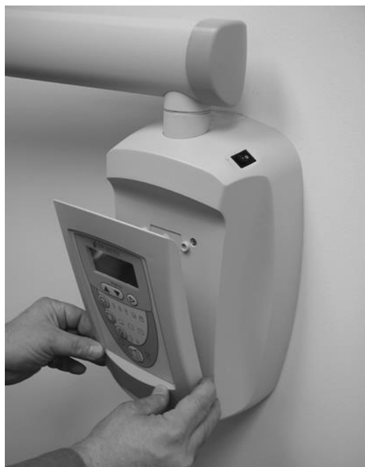
Rysunek 37 Montaż panelu operatora
