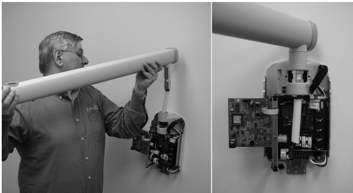
Rysunek 18 Montaż ramienia poziomego
